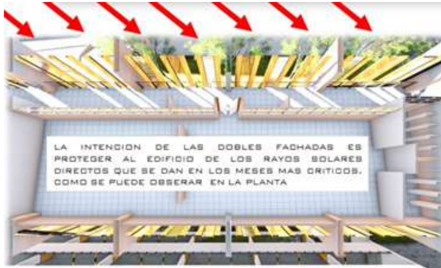
Ilustración 12: Fachada falsa para protección solar. Fuente: elaboración propia.
