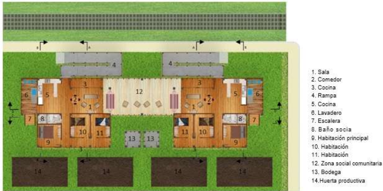
Ilustración 126: planta arquitectónica 1 nivel. Fuente: elaboración propia 2018.
