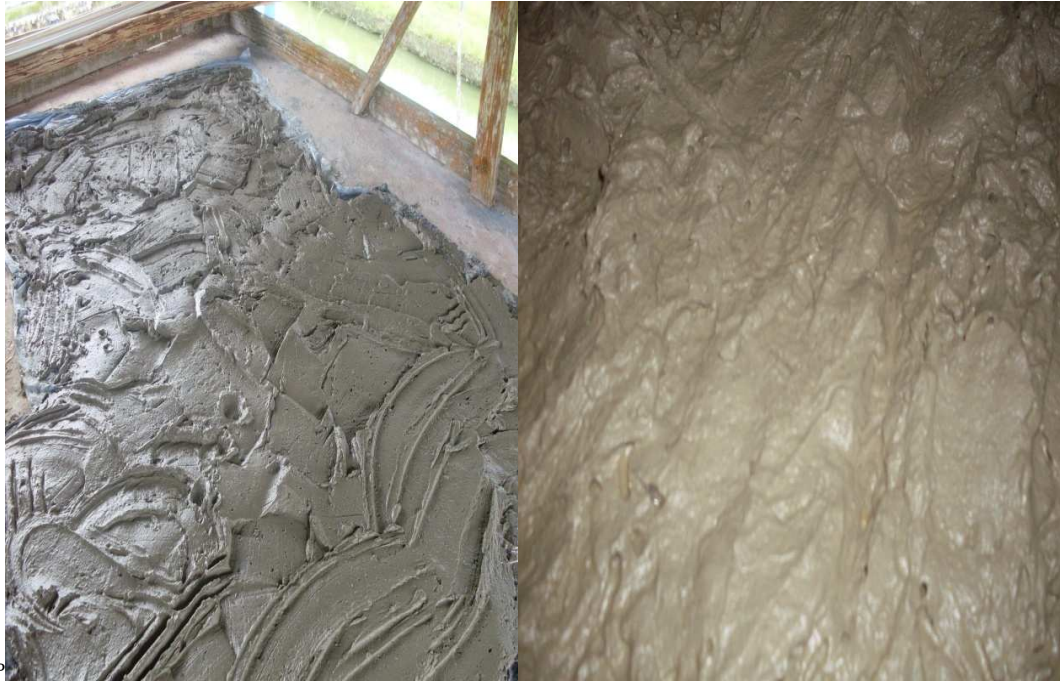
Figura 2. Secado de lodo sobre una superficie porosa bajo sombra Foto: M. Anchico Torres. (2008)
