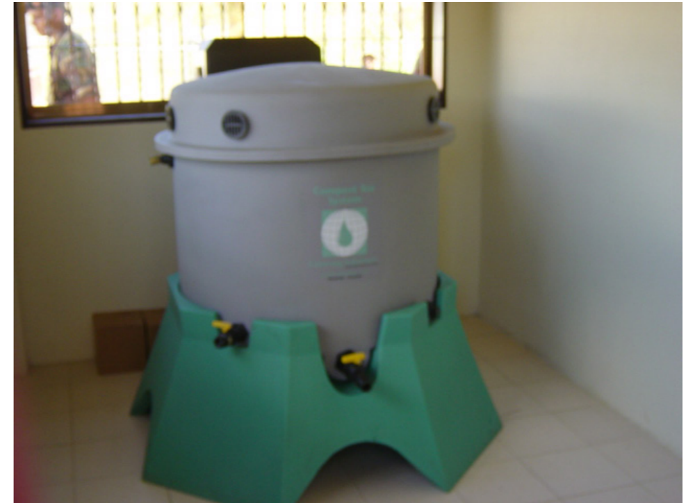
Fig. 1.9 Equipo de 400 litros de capacidad para la producción de té de compost.
