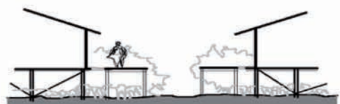
Figura 7. Perfil urbano en zonas bajas de estero. La calle sobre relleno deja de existir para dar paso a la pasarela desde la cual se accede a las viviendas palafíticas
