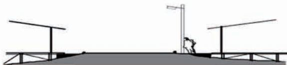
Figura 7. Perfil urbano en zonas bajas de estero. La calle sobre relleno deja de existir para dar paso a la pasarela desde la cual se accede a las viviendas palafíticas
