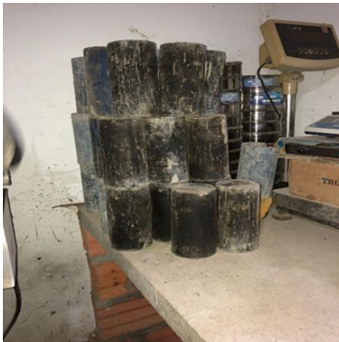
Ilustración 23 camisas cilíndricas para toma de muestra de concreto
