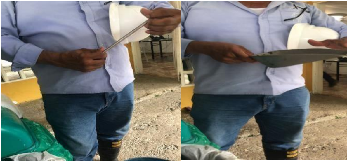
Ilustración 25 elementos utilizados para la toma de muestras del concreto varilla y cuchara
