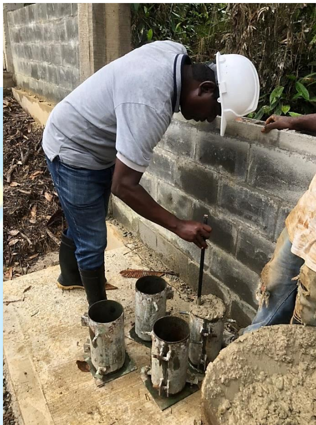
Imagen de ensayo realizado al concreto en obra – Fuente: Propia
