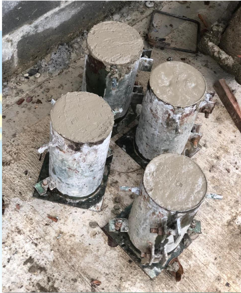
Especímenes de concreto obtenidos para ensayos - Fuente: Propia
