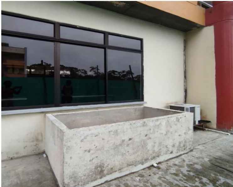
Ilustración 22. Tanque de curado de especímenes
